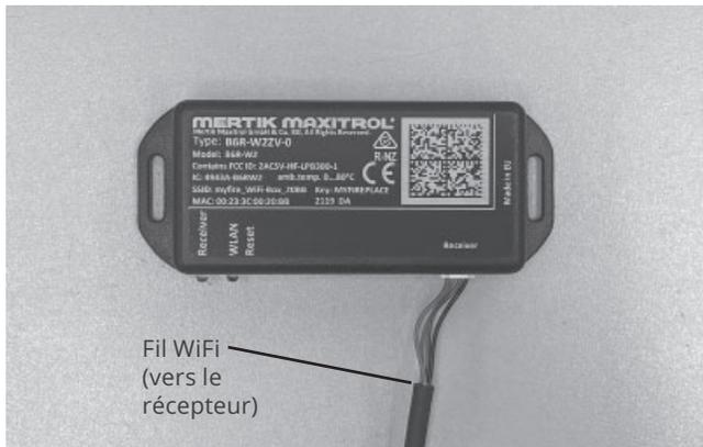
2. Collez une pièce de Velcro au module WiFi et placez-le derrière sous la boîte de foyer, à droite, tel qu'indiqué ci-dessous. Orientez le module pour que son bouton RESET soit facilement accessible.
