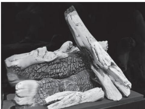
6. Placez la bûche de gauche insérant la cheville de la plateforme dans le trou de la bûche et plaçant l'autre bout de la bûche dans l'encoche formée par les noeuds sur la bûche arrière tel qu'indiqué.
