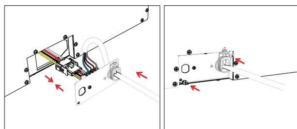
**IMPORTANT! Câblage 240 V : Menez L1 et L2 jusque dans le bornier; ne les liez pas ensemble hors de l'appareil.**
