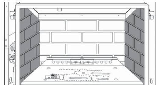
5. Resserrez les vis des supports d'ancrage de chaque côté.
