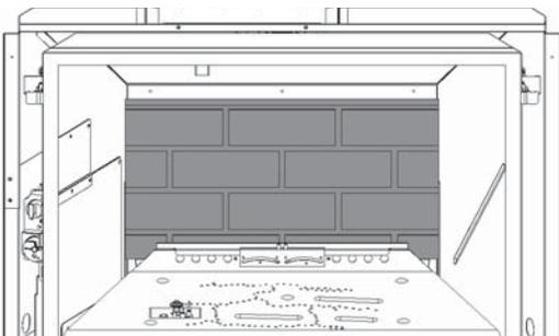
3. Pivotez le support d'ancrage du côté gauche vers le haut et placez le panneau gauche contre la paroi de la boîte de foyer. Pivotez le support vers le bas sur le panneau pour le maintenir en place.
