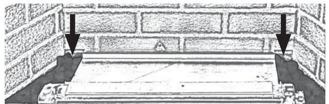
1. Centrez la bûche arrière entre les parois des côtés et assurez-vous qu'elle soit placée contre la languette avant du support de bûches.
