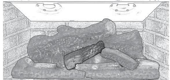
6. Identifiez la bûche de croisement gauche; elle a un trou sous son bout étroit. Placez son bout étroit sur la cheville de la bûche arrière. Posez son gros bout dans l'encoche sur la bûche avant-gauche à un angle approximatif de 30 degrés de l'axe central du foyer afin de permettre le passage des flammes devant la bûche arrière.
