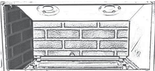
4. Pivotez le support d'ancrage du panneau vers l'arrière et glissez le panneau droit contre la paroi de la boîte de foyer. Pivotez le support d'ancrage vers le bas pour retenir le panneau.
