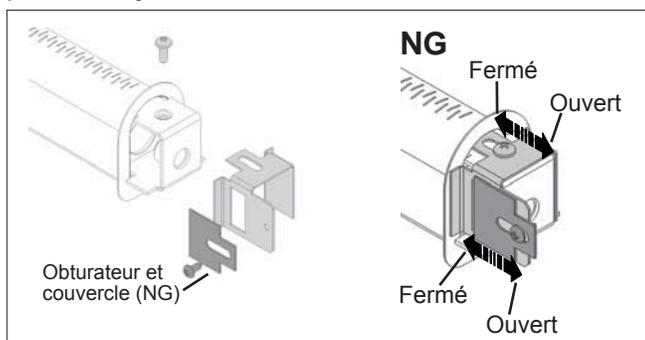
Cependant, dans certains cas inhabituels, l'aspect des flammes peut être amélioré en changeant le réglage de l'aération. La nécessité de réglage devrait être déterminée seulement après avoir fait fonctionner l'appareil avec les bûches et panneaux de céramique et avec la fenêtre installés.
