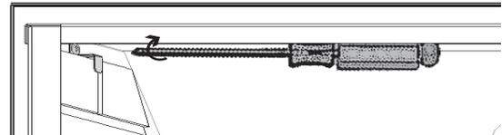
6. Installez le couvercle d'orifices à l'aide de deux vis tirées de la boîte de foyer.
