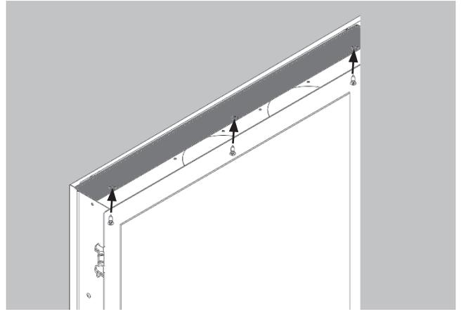
2. Insérez la plaque de finition dans la caisse de l'appareil et poussez-la jusqu'à ce qu'elle touche la finition du mur. Fixez-la avec 4 vis à profile bas noires fournies.
