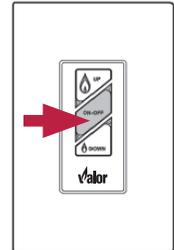
Si les flammes sont allumées, elles diminuent et vous entendez le moteur de la soupape tourner. Puis un claquement et un bip indiquant que la soupape a reçu la commande de la manette.
