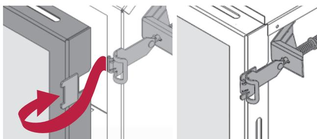
4. Tirez sur le haut de la fenêtre et relâchez-le afin de vous assurer que le mécanisme à ressort fonctionne bien.
