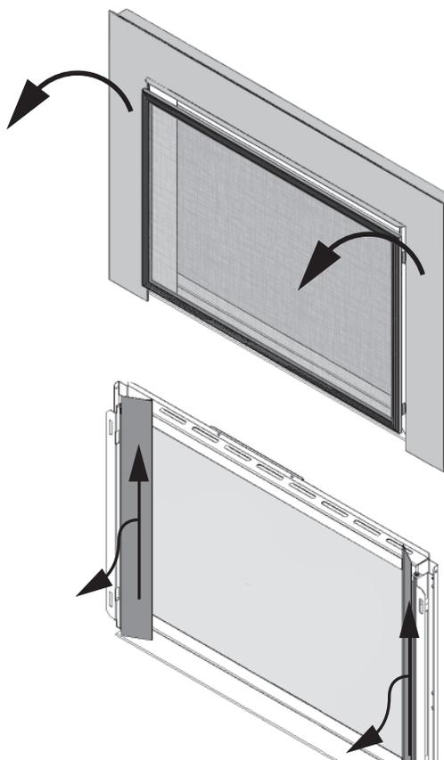
3. Repérez les deux leviers de chaque côté de la fenêtre vers le haut de la caisse. Tirez les leviers vers vous et décrochez-les des languettes de fixation de la fenêtre.
