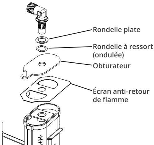
6. Remplacez le brûleur. La tige sur l'obturateur doit être insérée dans la fente du support de liaison..
