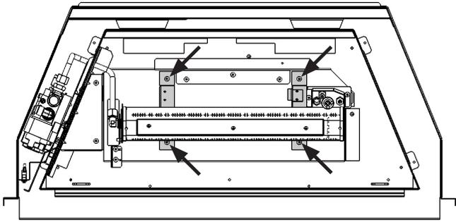
2. En soutenant l'injecteur coude, dévissez l'écrou retenant la conduite de gaz pour la débrancher. Sortez le rail du brûleur de la boîte de foyer avec l'injecteur coude toujours en place.
