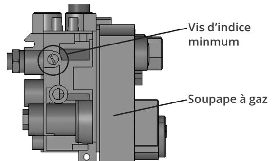
2. Insérez la vis de remplacement fournie avec le kit et serrez-la à la main avec un tournevis. Consultez les *Spécifications* à la page 6. Le numéro de la vis est inscrit sur sa tige.
