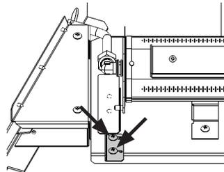
2. Pivotez le butoir dans la position correspondante au type de gaz utilisé. Le butoir est marqué avec les lettres N (gaz naturel) et P (gaz propane). Les illustrations ci-dessous indiquent la position pour chaque type de gaz.
