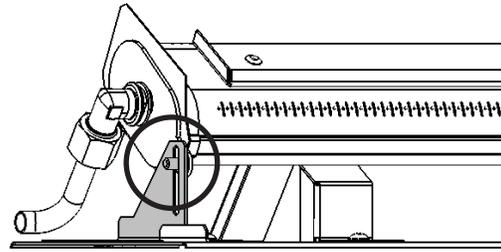
7. Rebranchez l'injecteur à la conduite de gaz. Serrez l'écrou. Le brûleur peut être ajusté pour l'alignement de l'injecteur à la conduite.
