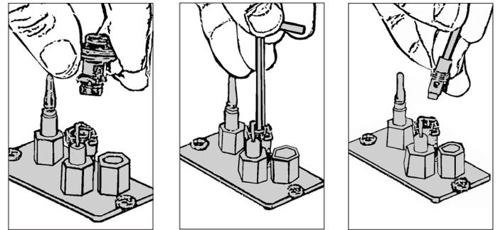
3. Remplacez-le avec l'injecteur approprié—voir le tableau *Spécifications* à la page 6. Installez le nouvel injecteur et serrez-le.
