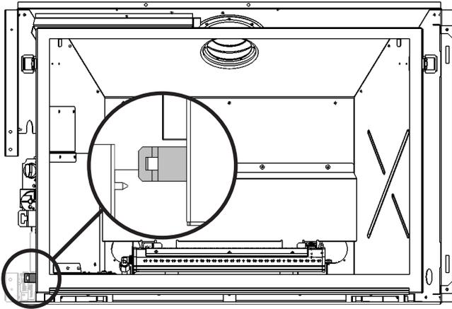
2. Ajustez la position de l'obturateur. Dépendamment du lit d'alimentation utilisé, de l'altitude et autre considérations, l'aspect des flammes peut être amélioré en changeant le réglage de l'aération. La nécessité de changer l'aération devrait être déterminée seulement après avoir fait fonctionner l'appareil avec le lit d'alimentation, les panneaux et la fenêtre installés et après avoir évalué les flammes suivant un réchauffement de 15 minutes. .
