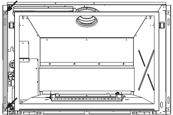
6. Enlevez la plaque d'accès sur le côté gauche de la caisse (2 vis sur le côté, 3 à l'avant).
