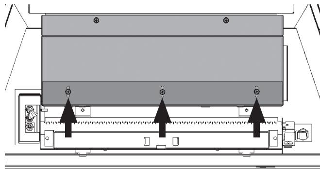
2. Installez la nouvelle pièce mobile fournie avec les bûches sur le support et fixez-la dans la même position que la partie originale. Les vis devraient être centrées dans les trous de fixation tel qu'indiqué.
