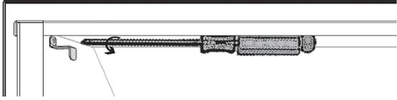
2. Placez le panneau arrière, côté lisse devant, contre la paroi arrière de la boîte de foyer, sur la languette du bas.
