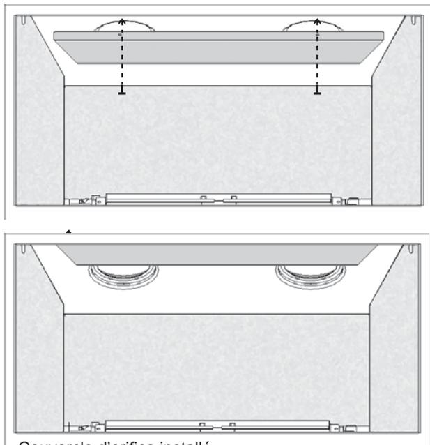
Couvercle d'orifice installé
