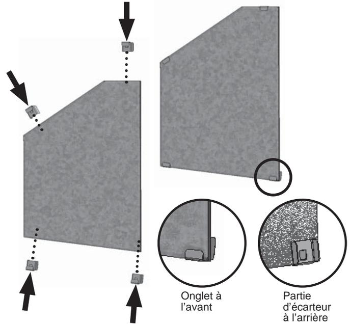
6. Pivotez le support d'ancrage du panneau vers l'arrière et glissez le panneau droit contre la paroi de la boîte de foyer. **Le panneau devrait être parallèle au bord de la plaque du brûleur.** Pivotez le support d'ancrage vers le bas pour retenir le panneau.
