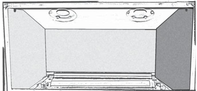
7. Resserrez les vis des supports d'ancrage des panneaux.
