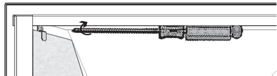
8. Installez le couvercle d'orifices à l'aide de deux vis tirées de la boîte de foyer.
