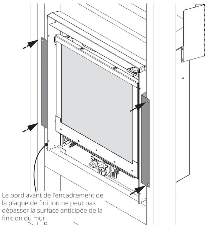
7. Fixez le panneau de béton au linteau et aux poteaux de chaque côté du foyer. Il y a un espace entre le bas du panneau et la caisse de l'appareil. Le panneau ne touche pas le dessus de l'appareil— laissez un espace approximatif de 1 pouce (25 mm).
