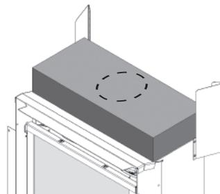
6. Insérez l'appareil dans l'encastrement et fixez les supports de montage aux poteaux de chaque côté avec deux vis à bois par côté (non-fournies). **Assurez-vous que l'installation soit nivelée.**
