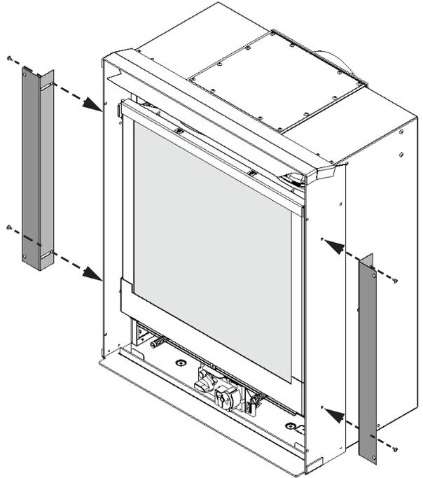
4. **Exigé pour installation dans une construction combustible.** Pliez les écarteurs et fixez-les à la caisse de l'appareil tel qu'indiqué (4 vis par côté, tirées de la caisse).
