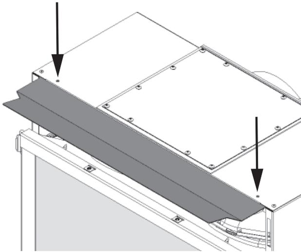
2. Placez l'encadrement de la plaque de finition autour de la caisse du foyer et fixez-le avec deux vis de chaque côté.
