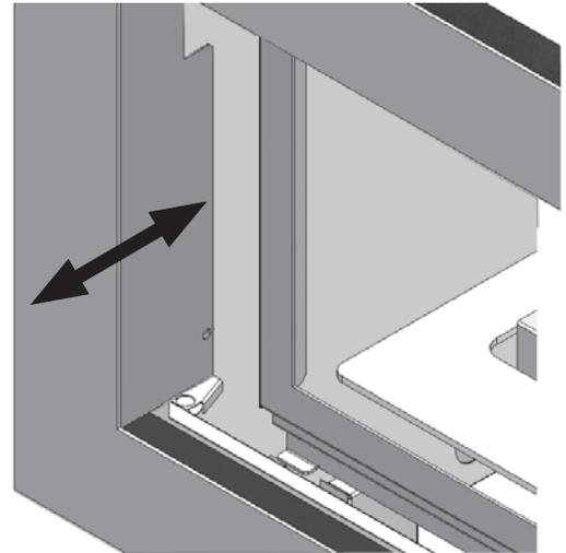
2. Sélectionnez un trou de fixation et fixez la bordure au foyer à l'aide de 4 vis n° 8.
