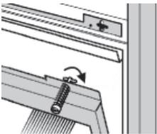
4. Tirez sur le haut de la fenêtre et relâchez-le pour vous assurer que le mécanisme à ressort fonctionne bien.
