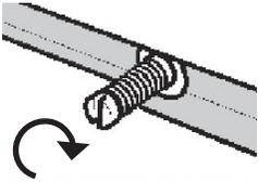
3. Installez les boulons du haut, insérant la tige du boulon dans la fente de la languette de fenêtre puis poussez et tournez à 90 degrés pour les fixer.
