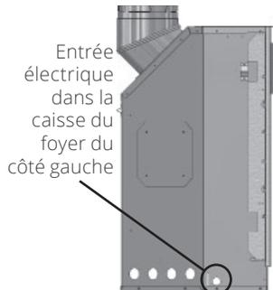
3. Placez la boîte de jonction dans la caisse de l'appareil sur le devant à gauche, puis insérez sa languette dans la fente située juste derrière la bague de serrage. Assurez-vous que les fils ne soient pas pincés entre la boîte de jonction et la paroi de l'appareil.
