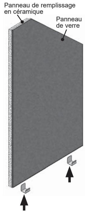
3. Placez le panneau de remplissage arrière sur le rebord de métal contre la paroi arrière de la boîte de foyer; placez par-dessus le panneau de verre, côté lisse visible, vous assurant que les deux panneaux soient retenus par les languettes de retenue. Tenez les panneaux en place.
