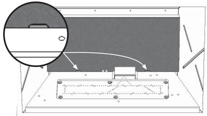
4. Installez un des assemblages de panneaux des côtés en le plaçant contre la paroi de la boîte de foyer. Glissez les panneaux contre les panneaux arrière.
