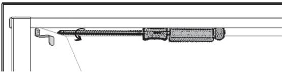
2. Placez le panneau de verre gauche, côté lisse visible, par-dessus le panneau de remplissage et agrafez-les ensemble à l'aide deux agrafes en bas tel qu'indiqué. Répétez avec le panneau de verre droit. Mettez les panneaux assemblés de côté.
