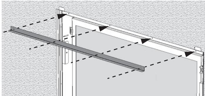
2. Enchâsssez la bordure dans l'ouverture de la caisse du foyer en plaçant ses supports des côtés contre les 4 supports de montage de la caisse. Fixez sommairement la bordure avec 4 vis à profile bas. Ajustez la position de la bordure contre la finition du mur et serrez les vis.
