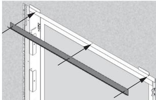
2. Enchâssez la bordure dans l'ouverture de la caisse du foyer en plaçant ses supports des côtés contre les 4 supports de montage de la caisse. Fixez sommairement la bordure avec 4 vis à profile bas. Ajustez la position de la bordure contre la finition du mur et serrez les vis.
