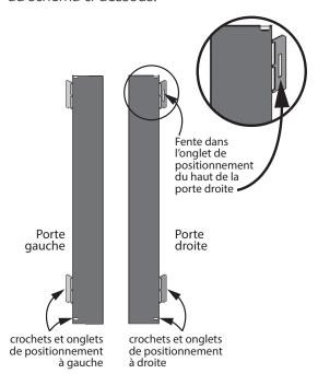
6. Installez la porte gauche en insérant ses onglets de positionnement dans les fentes situées juste derrière le façade de la bordure tel qu'indiqué.
