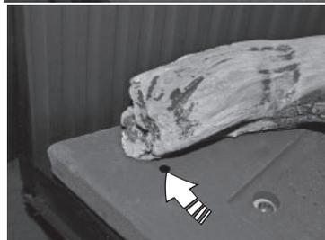
2. Placez la bûche droite du côté droit du brûleur en insérant ses deux chevilles dans les trous sur le brûleur. Le bout arrière de la bûche repose sur l'écran de la veilleuse.
