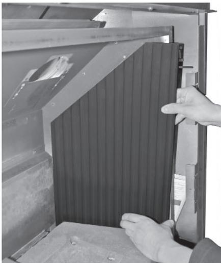
3. Placez le panneau arrière contre la paroi arrière de la boîte de foyer derrière l'onglet de retenue sur la rainure du bas et derrière le panneau de côté déjà installé.
