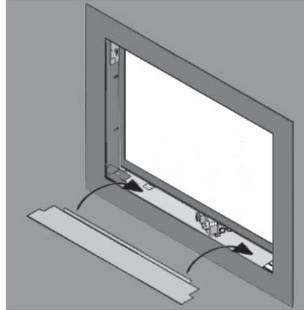
4. Ajustez la position du déflecteur de convection de chaque côté de la fenêtre. Dévissez l'écrou, tirez le déflecteur le plus en avant possible, resserrez l'écrou.
