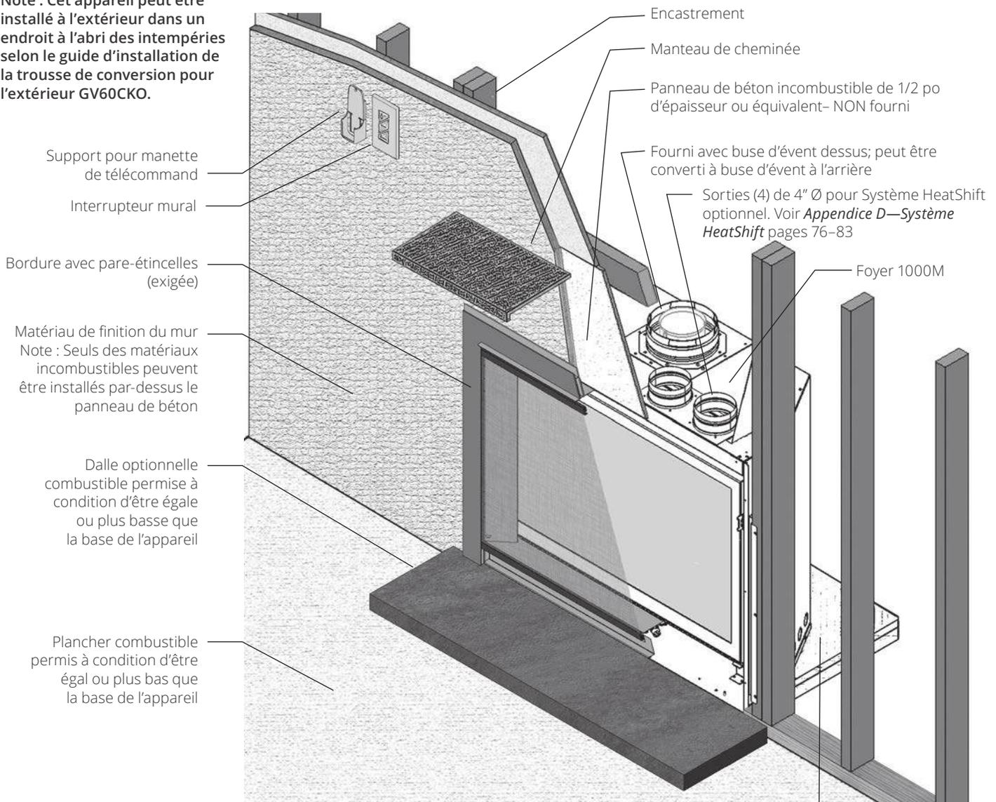
Charpente combustible permise sous l'appareil. Lorsque l'appareil est installé directement sur de la moquette, tuile ou autre matériau combustible autre que le bois, l'appareil doit être installé sur un panneau de métal ou bois couvrant son entière surface encastrée en largeur et en profondeur.
