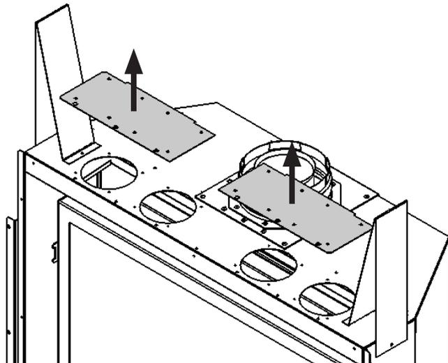
2. Installez les deux plaques à buses fournies avec le plénum sur la caisse de l'appareil (8 vis chacune).
