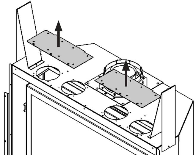
2. Installez les deux plaques à buses fournies avec le plénum sur la caisse de l'appareil (8 vis chacune).
