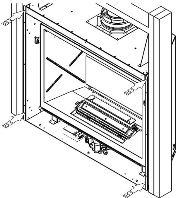
3. Sur la paroi du bas de l'appareil, enlevez les trois écrous. Installez le panneau du bas sur les trois chevilles filetées et fixez-le avec les écrous.
