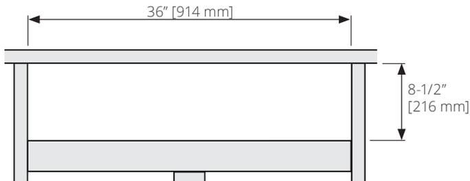
2. Installez le plénum dans l'encastrement en maintenant les dégagements minimaux aux combustibles tel qu'indiqué dans ce guide.
