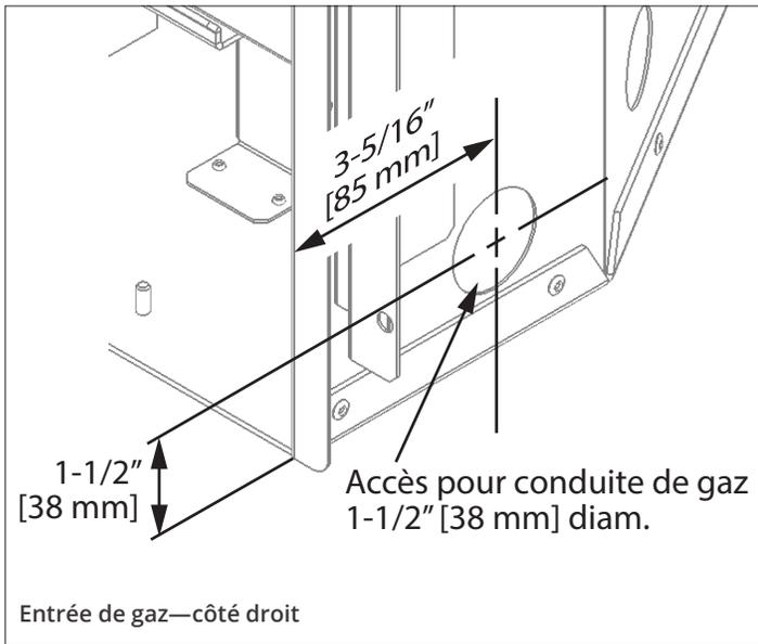
L'appareil inclut une conduite souple d'acier inoxydable afin de permettre le débranchement pour l'entretien. Un robinet d'arrêt manuel (non-inclus) doit être installé sur la conduite d'alimentation en amont de la conduite souple.
