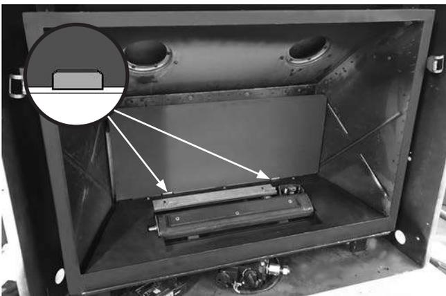
4. Insérez un des panneaux des côtés entre la plateforme du brûleur et la paroi de côté de la boîte de foyer. Pivotez le support d'ancrage sur le panneau pour le tenir en place.
