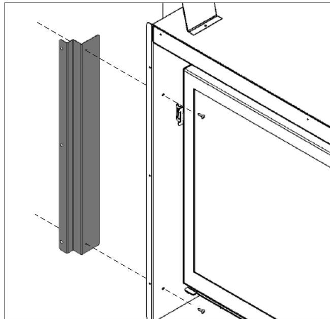
2. En faisant attention de ne pas vous couper, soulevez l'appareil et placez-le dans la charpente. **Assurez-vous que l'appareil est à la bonne hauteur en considérant la hauteur de la dalle ou plancher protecteur ou du plancher combustible.**
