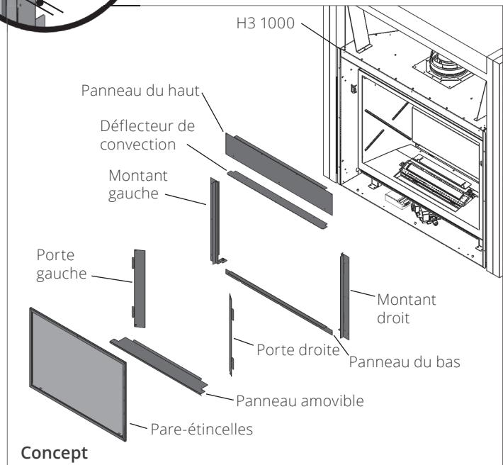
L'Encastrement 1030 s'installe au foyer au moment de l'encastrement dans la charpente et la position de l'appareil est fixe. Les matériaux de finition du mur sont ensuite appliqués en couvrant le kit jusqu'au périmètre du cadre.
