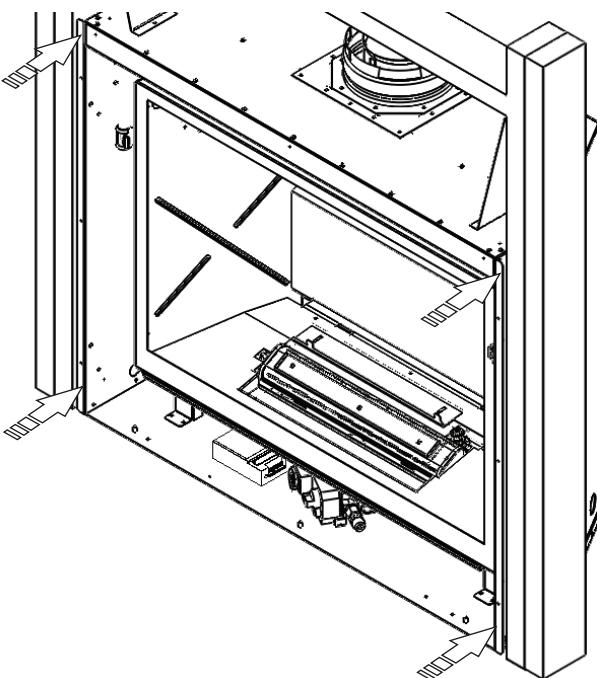
2. Sur la paroi du bas de l'appareil, enlevez les trois écrous. Installez le panneau du bas sur les trois chevilles filetées et fixez-le avec les écrous.
