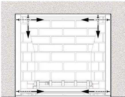
3. Installez la plaque de soutien et fixez-la avec 2 vis au haut; réinstallez la plaque de seuil et fixez-la avec la plaque de soutien à l'aide de 1 vis de chaque côté, tel qu'indiqué.
