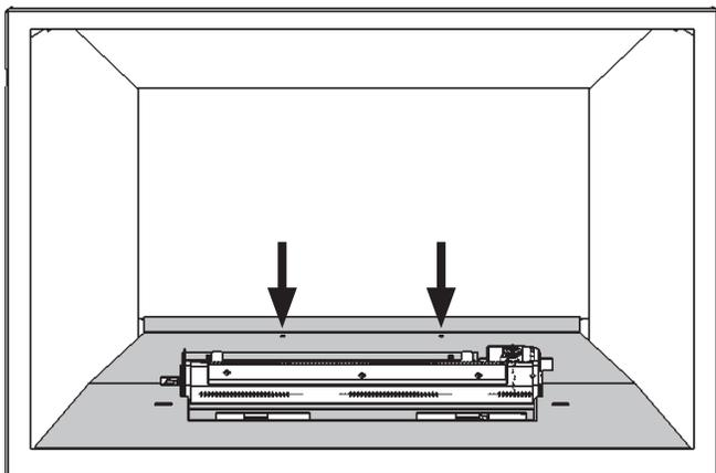
8. Resserrez les vis des supports d'ancrage de chaque côté.
