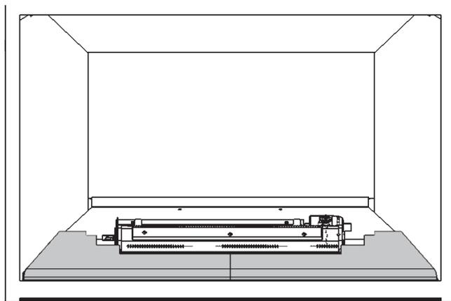
Un couvercle de métal est fourni avec les briques avant; il est utilisé avec le lit de combustion Bois de grève 1000DWKV2—voir à la page 26. Si vous installez un autre lit de combustion, cette pièce n'est pas utilisée. Jetez ou recyclez-la.
