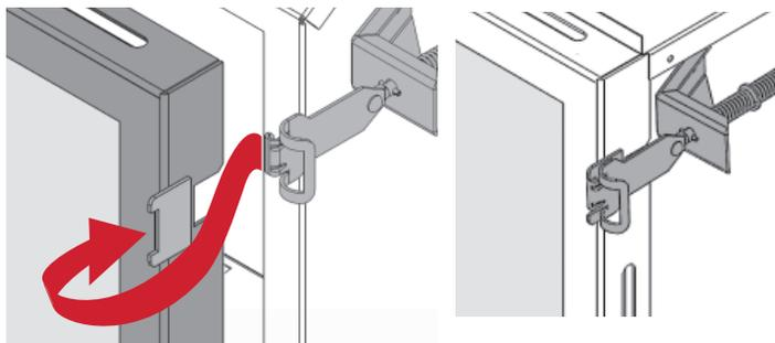
3. Tirez sur le dessus de la fenêtre et relâchez-le afin de vous assurer que le mécanisme à ressort fonctionne bien.
