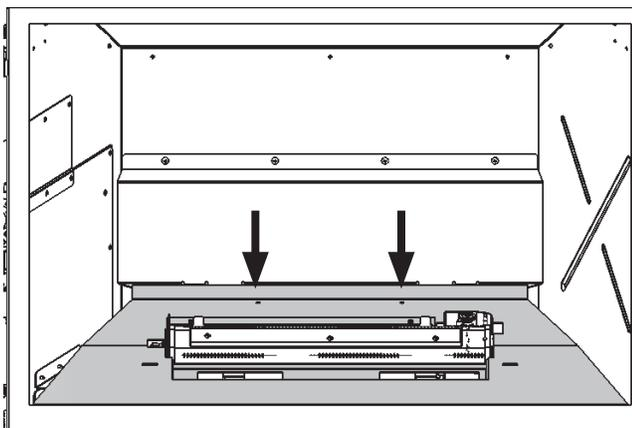
3. Pivotez le support d'ancrage du côté gauche vers le haut et placez le panneau gauche contre la paroi de la boîte de foyer. Pivotez le support vers le bas sur le panneau pour le maintenir en place.
