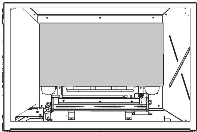
5. Pivotez le support d'ancrage du côté droit vers le haut et placez le panneau droit contre la paroi de la boîte de foyer. Faites attention au coin avant du panneau pour ne pas le briser. Pivotez le support vers le bas sur le panneau pour le maintenir en place.
