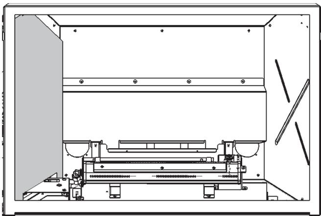
4. Placez le panneau arrière contre la paroi de la boîte de foyer sur le rail au bas. Glissez le panneau derrière le panneau gauche.
