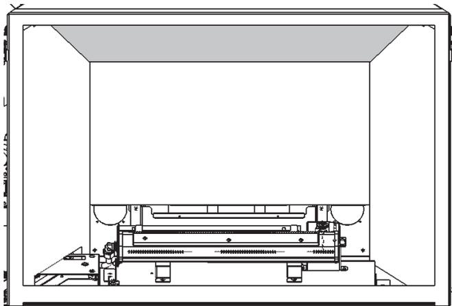
7. Remplacez le couvercle du brûleur, en commençant par l'arrière puis l'avant (2 vis à l'arrière).
