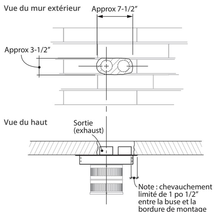
2. Faites une installation préliminaire des conduits souples de 3 pouces homologués en les passant par le registre existant et à travers le trou percé dans le mur extérieur de maçonnerie en prenant soin de laisser assez de longueur à l'extérieur pour le raccordement à la sortie murale.
