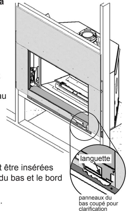
9. Il y a une porte d'accès pour la gauche et une pour la droite. Elles peuvent être identifiées par la position de l'onglet—qui doit se trouver au bas. Insérez la cheville du haut de la porte dans le support de charnière du haut situé juste derrière le devant du foyer tel qu'indiqué.
