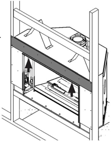
3. Placez l'appareil dans l'encastrement de façon à ce que sa base soit égale à la poutre de la charpente. Les panneaux du kit devraient couvrir en partie les poteaux de l'encastrement. Fixez les panneaux à la charpente à l'aide 10 vis à bois.
