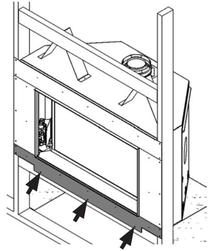
5. Fixez les panneaux de béton du haut, des côtés, et du bas au devant de la caisse de l'appareil à l'aide de 14 vis fournies.
