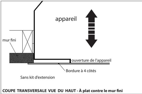
Si vous désirez installer la bordure à plat contre le mur fini, le kit d'extension n'est pas nécessaire. Enlevez les vis retenant l'appareil à la charpente, installez la bordure et poussez l'appareil dans la cavité jusqu'à ce que la surface arrière de la bordure touche le mur. Revissez l'appareil à la charpente.
