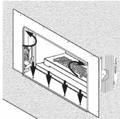
Enlevez les vis retenant le foyer à la charpente de l'intérieur de la caisse du foyer de chaque côté et devant la fenêtre.
