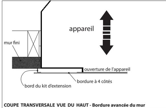
Si ça n'est pas le cas, la position de l'appareil dans la charpente doit être modifiée. Enlevez la vis retenant l'appareil à la charpente de chaque côté (de l'intérieur de la caisse) de même que les quatre vis retenant l'appareil au sol ou à la poutre du dessous.
